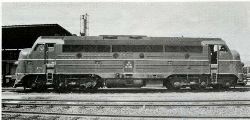
Lokomotiv litra Mv nr 1109 Diesel-elektrisk kraftoverføring Max hastighed med tog 133 km/t 1700 HK Længde over puffer 18,90 m Tjenesteklar vægt 98,6 tons Dampvarme Byggeår 1956
