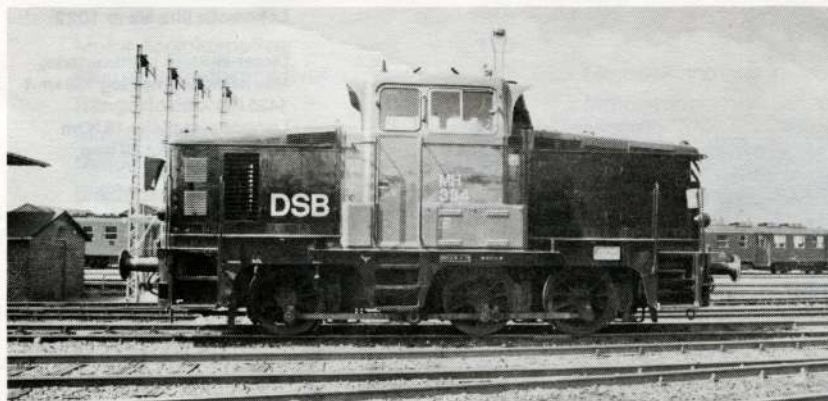
Lokomotiv litra Mh nr 334 Diesel-hydraulisk kraftoverføring Max hastighed med tog 60 km/t 440 HK Længde over puffer 9,40 m Tjenesteklar vægt 40,5 tons Byggeår 1962
