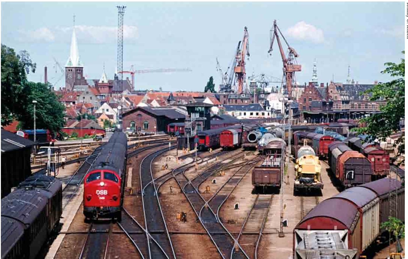
Vue udover Helsingør station den 18. juni 1983, hvor MY 1149 afgår med regionaltog mod København. Selve godsterrænet var knebet ind mellem hovedsporene og opmarchbanerne for biloverfarten, og levede kun begrænset plads til opbevaring af godsvogne til og fra færgerne.
